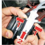
**3** Bauen Sie den Cappuccinatore auseinander. Reinigen Sie die Einzelteile gründlich. Entfernen Sie Milchreste aus den Löchern. Prüfen Sie die Dichtungen.
