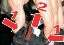
**2** Bauen Sie den Cappuccinatore aus dem Kaffeeauslauf aus. Entfernen Sie Silikonschlauch No. 3 und No. 4.
