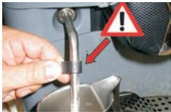
**1** Drücken Sie die Dampf-taste, um die Dampf-düse zu reinigen.
